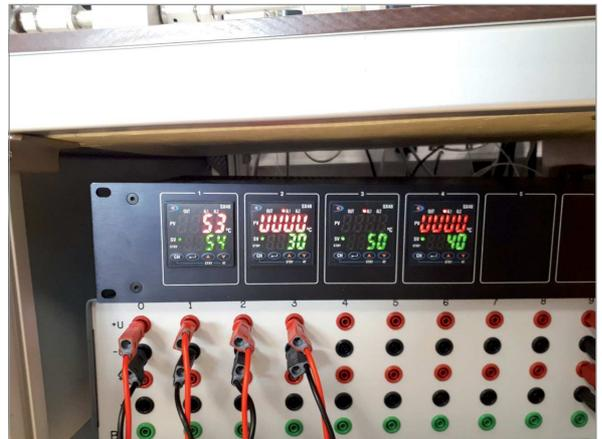
Au cours du projet HIT, des adaptations ont permis d'étendre les gammes de fonctionnement des moyens d'étalonnage actuels. Pour éviter la présence de « points froids » dans le système lorsque la température de rosée atteint +90°C, des dispositifs additionnels de chauffage, associés à leur régulateur, ont été intégrés.
