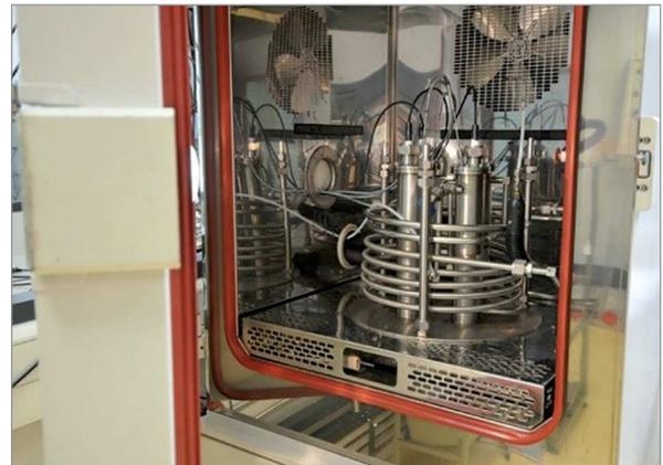
Pour l'extension jusqu'à +140°C, portant sur la température des étalonnages en humidité relative, les travaux ont consisté essentiellement en une caractérisation plus étendue du moyen existant. Ce travail s'est prolongé avec la définition de l'humidité relative pour des températures supérieures à +100°C. On voit ici l'enceinte thermostatique intégrant la chambre d'essais (à gauche) et le détail de la chambre d'essais (à droite).
