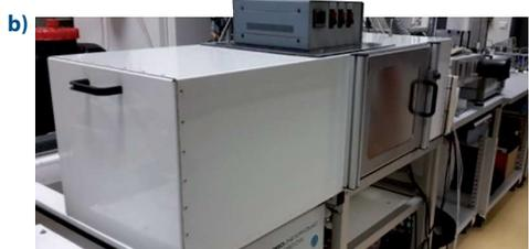
Les bancs d'étalonnage sont équipés de capots de confinement, qui sont régulés en température au moyen de sources de chauffage intégrées sur la face supérieure des capots. L'élévation de la température de rosée à +80°C (a) et +90°C (b) a nécessité de concevoir de nouveaux capots ayant une isolation thermique supérieure et une meilleure homogénéité en température.
